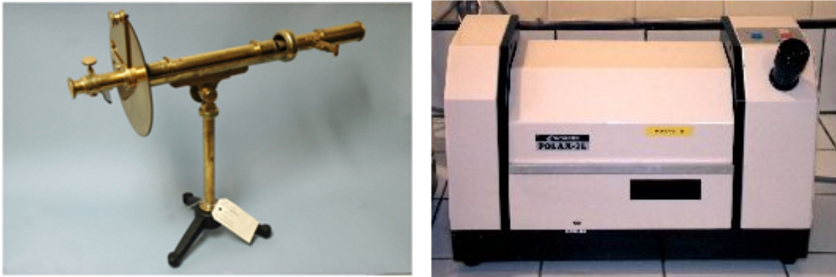
Figure 4 : Polarimètre à double graduation à pénombre dit "de Laurent", Pays de la Loire, années 1900 © Université de Nantes et Polarimètre Atago Polax-2L, Auvergne, années 1975 © Musée Lecoq
